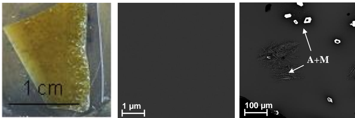
Figure 7. (a) Photo de l'échantillon de verre TR14Mo3,5 refroidi lentement à 1°C/min de 1300°C à la température ambiante. (b) Cliché MEB-FEG en électrons rétrodiffusés du cœur de l'échantillon. (c) Cliché MEB-FEG en électrons rétrodiffusés de l'interface verre/creuset de l'échantillon. A : apatite \text{Ca}_2\text{TR}_8(\text{SiO}_4)_6\text{O}_2 ; M : molybdates (sphérules riches en molybdène, calcium et sodium d'après les analyses EDX).
