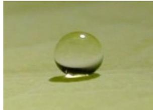
FIGURE 3 – Une goutte d'eau posée sur une feuille de Lotus forme un angle de contact proche de  $180^\circ$ . Photo : M. Reyssat et S. Saint-Jean.
