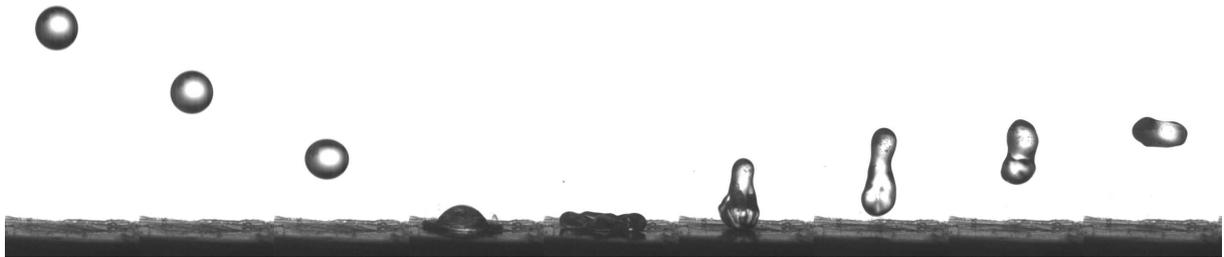
FIGURE D.2 – Impact d'une goutte d'eau de rayon 1.2 mm arrivant à 1 m/s sur une surface de carboglace. Intervalle entre deux images : 4 ms.
