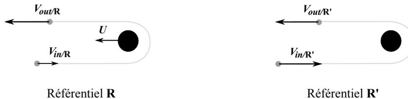
FIGURE 2.20 – Schéma de l'interaction entre une goutte et un aimant en mouvement à vitesse  $U$  dans le référentiel du laboratoire  $\mathbf{R}$ . Le référentiel  $\mathbf{R}'$  est le référentiel de l'aimant, dans lequel les vitesses initiales et finales de la goutte sont identiques. La déflexion est fixée à  $180^\circ$ .
