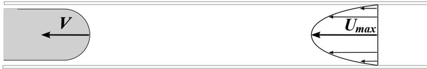
FIGURE 5.9 – Schéma de l'écoulement derrière une goutte dans le référentiel du tube. La goutte se déplace à vitesse  $V$ , entraînant avec elle du liquide dans le tube. Loin de la goutte, on s'attend à un écoulement de Poiseuille, dont la vitesse maximale  $U_{max}$  est différente de  $V$ .
