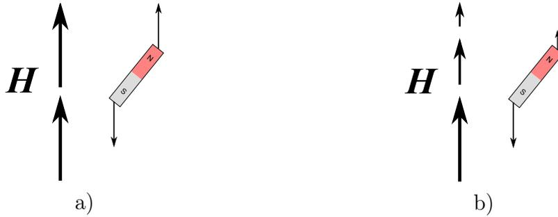
FIGURE 1.12 – a) Dipôle magnétique dans un champ  $H$  uniforme. La somme des forces est nulle mais le couple n'est pas nul et oriente le dipôle dans le sens du champ  $H$ . b) Dipôle dans un champ variable. La résultante des forces est orientée vers les valeurs de  $H$  élevées.
