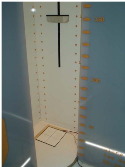
a - 1 er prototype de plate-forme de force installée dans un socle dédié sur le sol de la cabine EOS TM .
