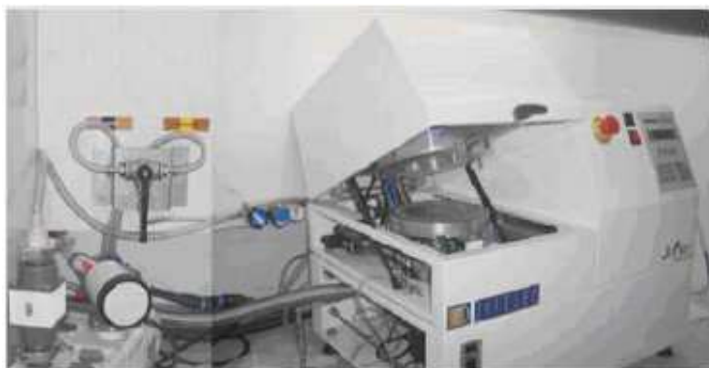
Figure 2.7. Four infrarouge, utilisé pour les recuits rapides
