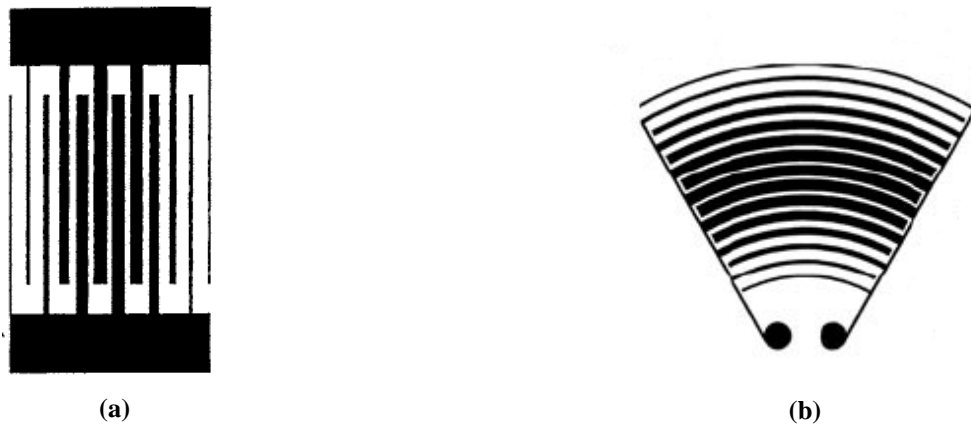
Figure 0-6: Schéma d'un traducteur interdigité (a) rectangulaire (b) circulaire [16].
