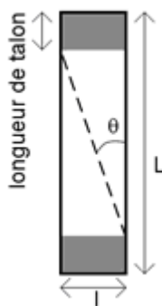
Figure 31 : Schéma d'une éprouvette EDT- L : longueur de l'éprouvette; l : largeur de l'éprouvette; e épaisseur de l'éprouvette [109]
