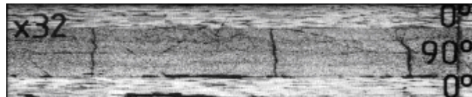
Figure 28 : Fissures transverses dans un stratifié [0_n, 90_m]_s [105]
