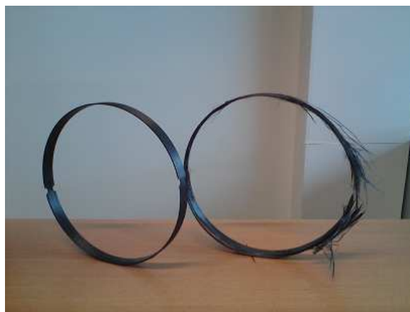
Figure 110 : Localisation de la rupture avec l'insertion d'entailles
