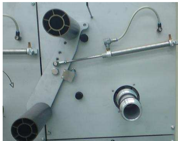
Figure 101 : Schéma et photo d'un dispositif de compensateur de tension
