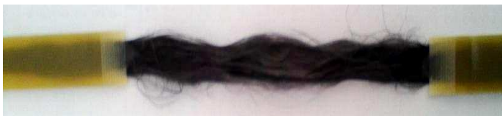
Figure 40 : Ruban de fibre de carbone après essai
