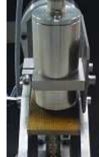
Figure 103 : Emetteur infrarouge (photo de gauche) et pyromètre laser (photo de droite) utilisés respectivement pour le chauffage et la régulation de température au niveau de la tête de dépose
