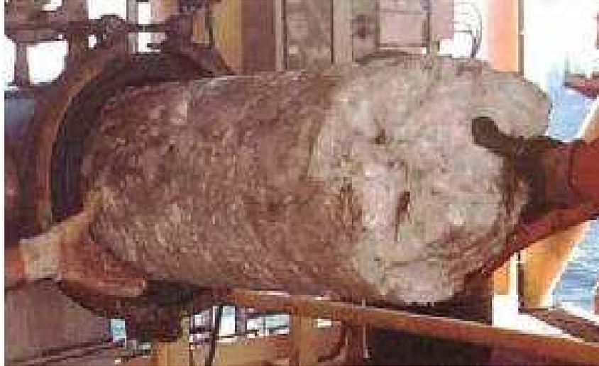
**Figure 16.** Pipeline bouché par un bloc d'hydrate, (<http://methanol-recovery.com>)
