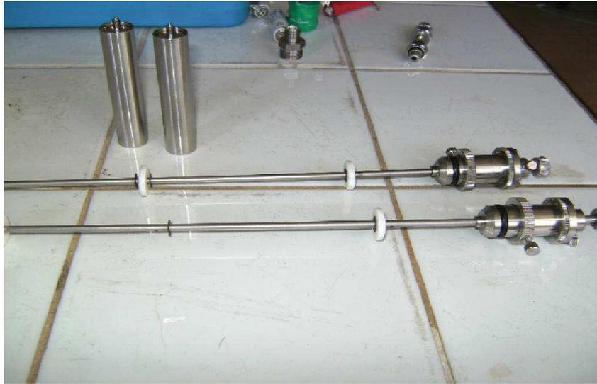
**Figure 43.** Cellule de mesure et cellule de référence
