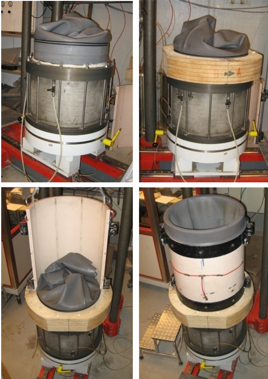
Figure II-17 Différentes étapes du montage du moule
