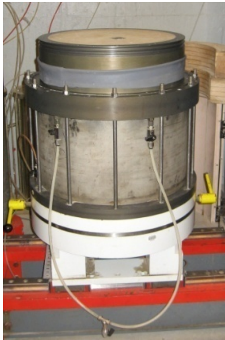
Figure II-3 Vue du dispositif de pressurisation verticale sur rails de guidage
