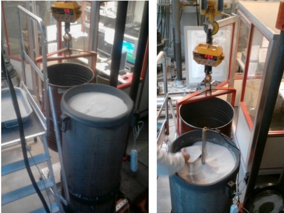
Figure II-24 Vidange et pesage du sable en fin d'essai
