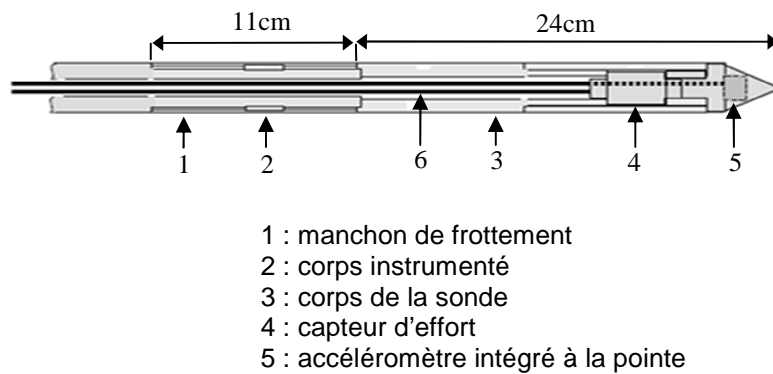
Figure II-6 Schéma simplifié de la sonde de 36mm
