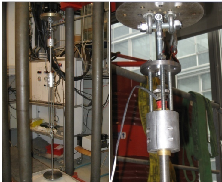
Figure II-9 Dispositif d'étalonnage du capteur de frottement de la sonde
