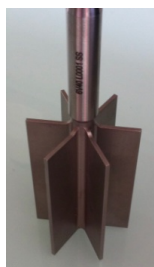
FIGURE III.33 – Photographie d'une géométrie de type vane à 6 pales
