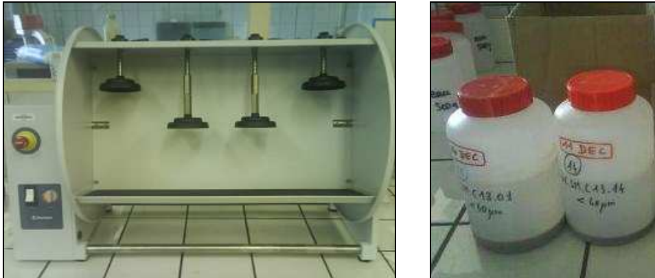
Figure 18 : Agitateur rotatif HEIDOLF Reax 20 (vitesse de rotation : 15 t/min) et flacons en polypropylène de 1L utilisés pour les essais batch.
