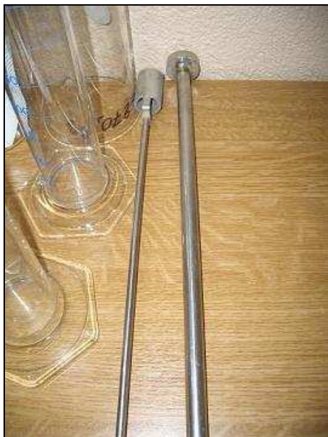
Figure 29 : Nacelle et tampon utilisés pour le remplissage des colonnes
