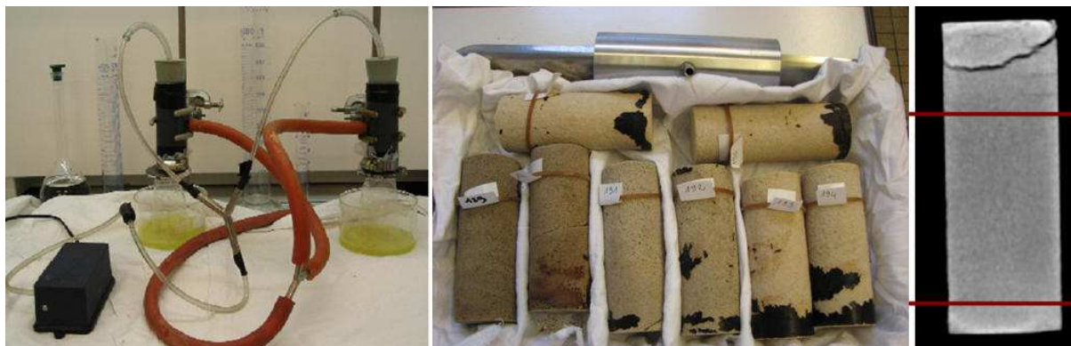
Figure III-22. À gauche: Configuration du processus; au milieu: échantillons et moule; à droite: image CT-scanner montrant des anomalies aux extrémités.
