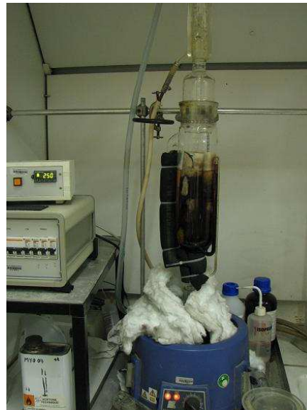
Figure III-6. Schéma de principe (d'après Zinszner et Pellerin, 2007) et photographie de l'extracteur Soxhlet disponible à IFPEN.
