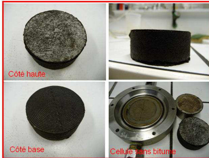
Figure IV-7. Photographie de l'échantillon et de la cellule après l'essai (OS_OED2, jusqu'à 46 MPa).
