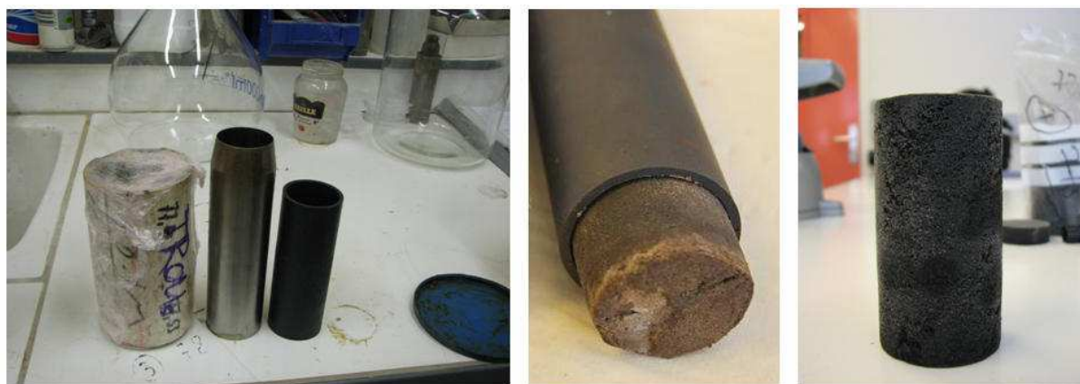
Figure III-30. Préparation des échantillons de sables bitumineux Canadiens. À gauche: un tronçon dans sa gaine en PVC initiale à carotter et le carottier métallique avec la membrane de 38 mm. Au milieu: Échantillon avec la membrane à la sortie du carottier; À droite: échantillon avant l'essai.
