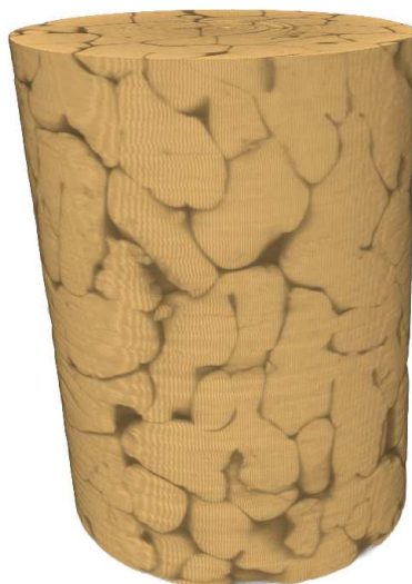
Figure 3 : représentation 3D d'un cylindre obtenue par tomographie X au synchrotron de Grenoble (ESRF) 500 \mu m x 1433 \mu m (MAD 06)
