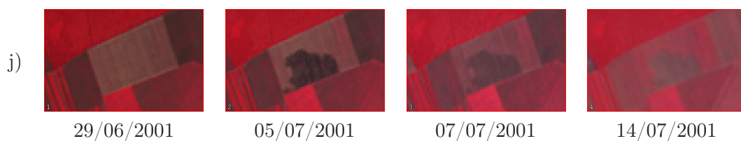
FIGURE 3.8 – Brûlis. On voit apparaître une zone naturelle sombre. L’assombrissement est souvent lié à de l’humidité dans la terre. Cependant étant donnée la date, il paraît peu probable que la terre s’humidifie de façon naturelle sur cette zone. On sait par ailleurs que la culture sur brûlis se pratique dans cette zone; il s’agit donc plus probablement d’un brûlis.
