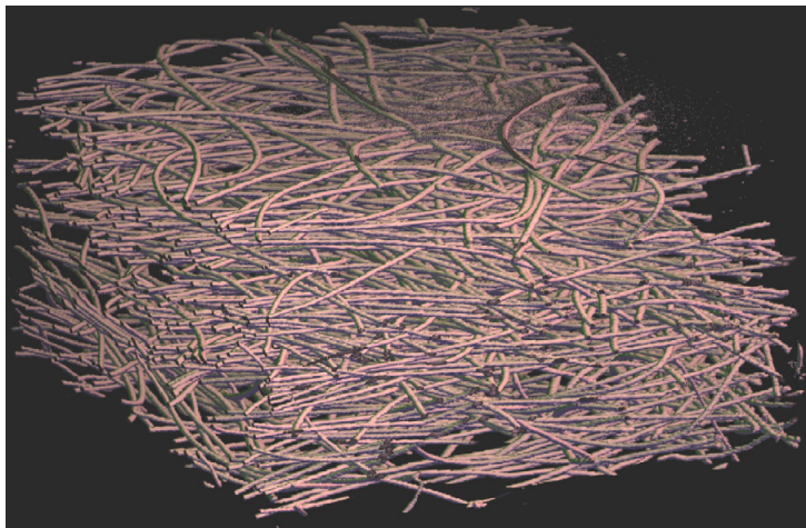
FIGURE 3.1 – Volume digitalisé d'un mat avec une résolution de 1.77 \mu\text{m} par voxel [JVTP08]
