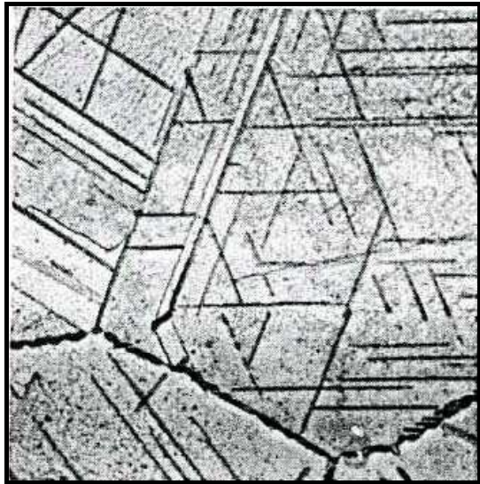
Figure 39: Alliage CuTi3 vieilli à 700°C durant 480min. x500 [1959DOI]
