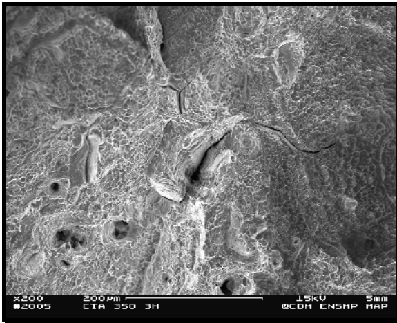
Figure 4 : Faciès de rupture d'une éprouvette revenu à 350^{\circ}C durant 3 heures à partir de l'état filé trempé, mettant en évidence la fragilité intergranulaire dans les zones ductiles (M.E.B/é secondaires)
