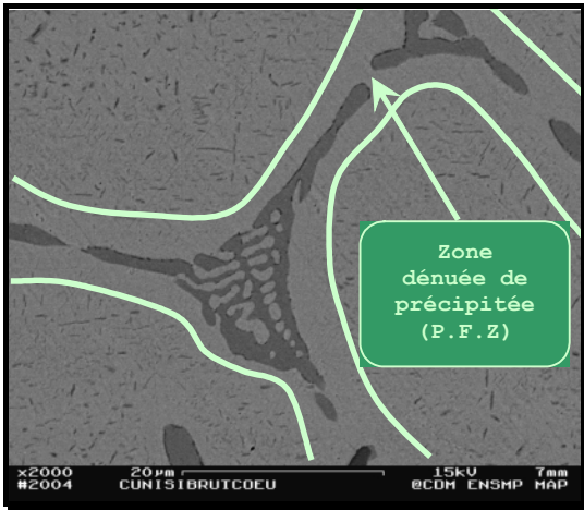
Figure 15: Observation de la phase riche en nickel et silicium à un point triple. La morphologie de la phase laisse supposer qu'elle s'est formée par réaction eutectique ou eutectoïde. (M.E.B / e - rétrodiffusés/ Polissage mécanique)
