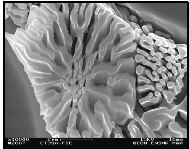
Figure 67: Le filage à chaud de l'alliage CuTi3Sn2.75 n'a pas induit le fractionnement de l'eutectique CuTiSn à la différence de l'alliage CuTi3Al2 (M.E.B/e secondaires/Polissage électrolytique)
