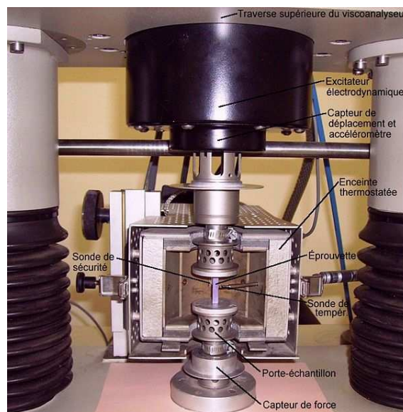
Figure A. 10 : Photographie d'un DMTA (Métravib VA815-RDS)
