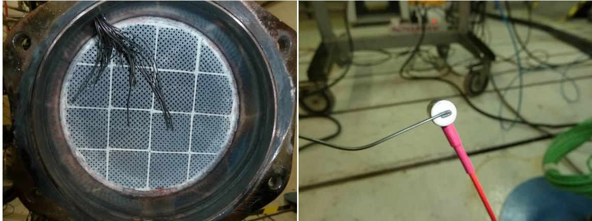
Figure 42: A gauche, vue de la face arrière du filtre : le guide d'onde est le fil isolé dans le quart non-instrumenté de thermocouples en bas à gauche de l'image. A droite, vue de la liaison entre le fil et le capteur
