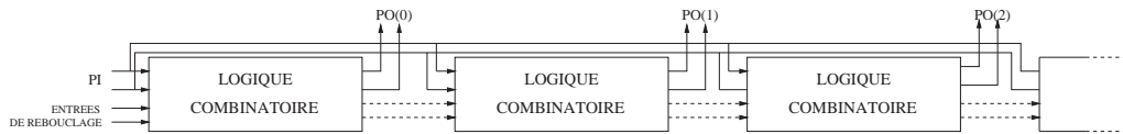
FIG. B.2 – Modélisation d'un circuit séquentiel comme une suite de circuits combinatoires.
