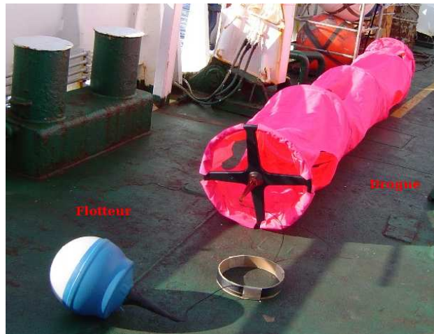
FIGURE 2.4 – Photo d’un drifter avec sa drogue dépliée.
