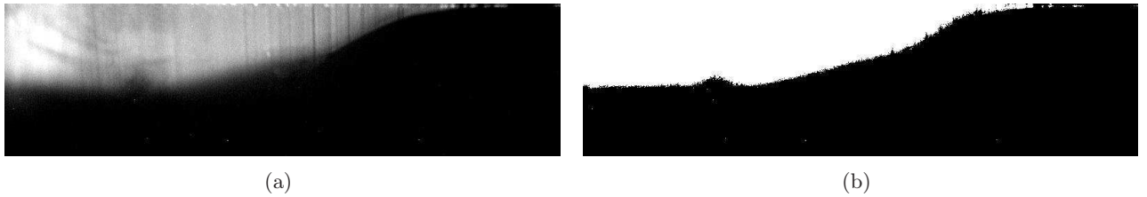
FIGURE 5.9 – Traitement des enregistrements LIF. (a) Image brute, l'eau légère mélangée à la rhodamine apparaît fluorescente. On observe ici l'état ajusté du courant géostrophique. (b) Binarisation de l'image pour mesurer la profondeur de la couche d'eau.
