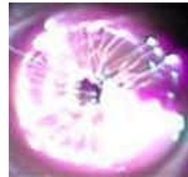
Fig.80 - Photographie de la décharge en régime filamentaire
