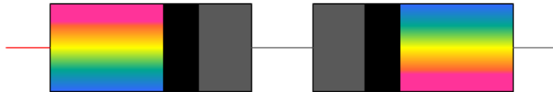
Figure 1: Régénérateur 3R formé de deux transpondeurs dos-à-dos.
