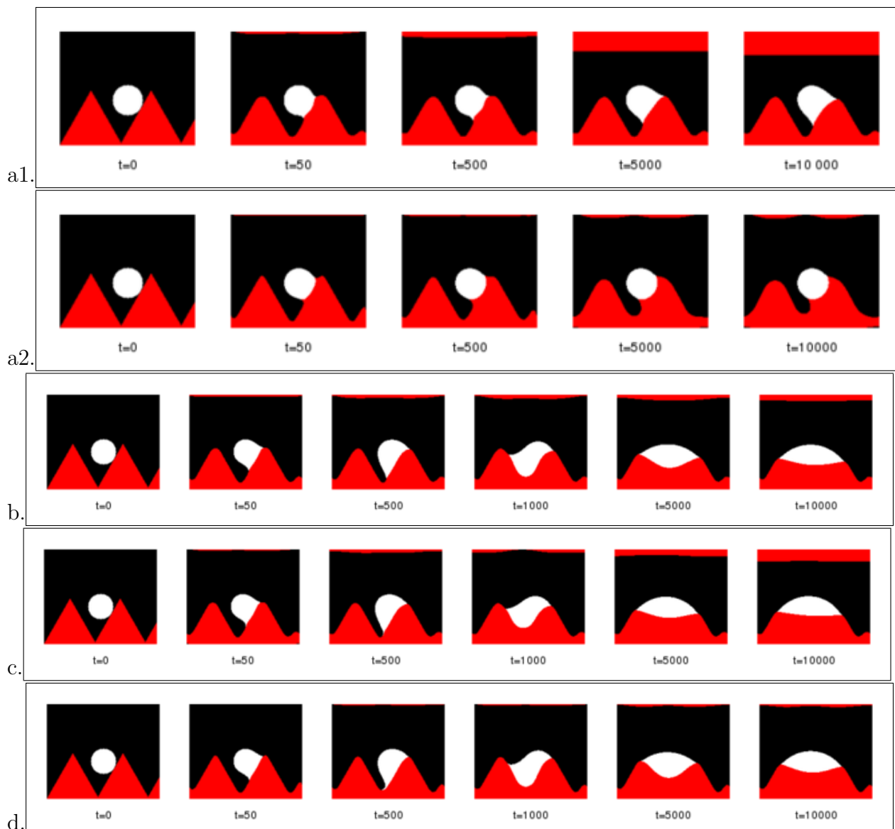
FIG. 3.23 – Evolution temporelle avec différents paramètres (voir table 3.4) pour déformer la diffusion de matière dans le liquide (a), dans le solide (b), dans la vapeur (c) et dans le solide et la vapeur à la fois (d) et avec \sigma_{VS} > \sigma_{VL} \sigma_{VL} = \sigma_{LS} (a1,b,c,d) et \sigma_{LS} > \sigma_{VL} \sigma_{LS} = \sigma_{SL} (a2).
