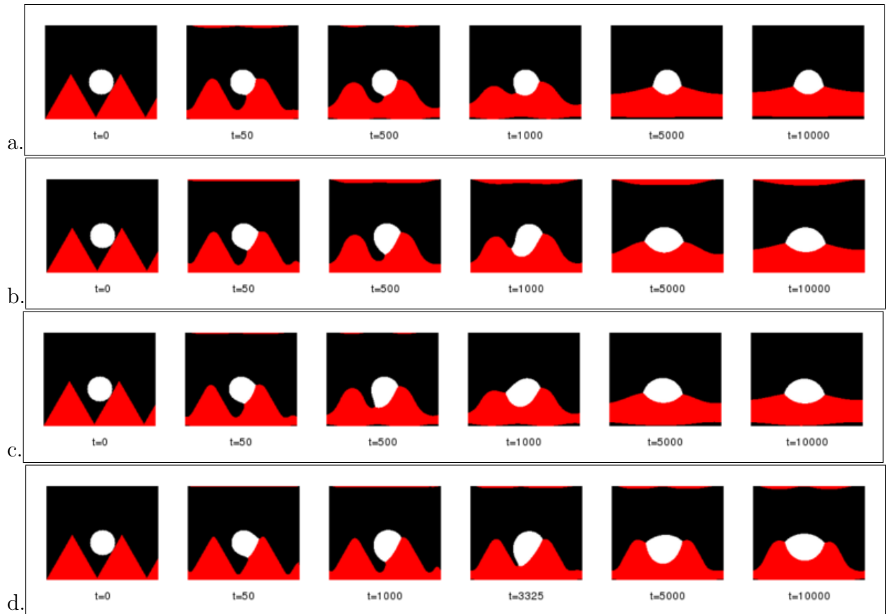
FIG. 3.22 – Evolution temporelle avec \sigma_{VL} = \sigma_{VS} = \sigma_{LS} et différents paramètres (voir table 3.4) pour défavoriser la diffusion de matière dans le liquide (a), dans le solide (b), dans la vapeur (c) et dans le solide et la vapeur à la fois (d).
