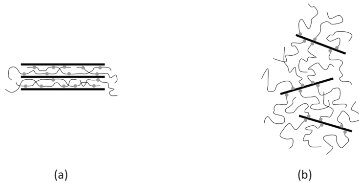
Figure 1.33 : Morphologies favorisées par l'utilisation de polypropylène fonctionnalisé le long de la chaîne polymère (a) et à l'extrémité de la chaîne polymère (b), d'après [Wang et al. (2003)]
