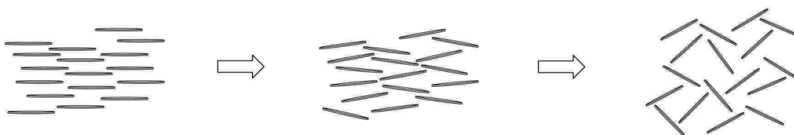
Figure V.18 : Schéma de la désorientation/percolation des feuillettes d'argile
