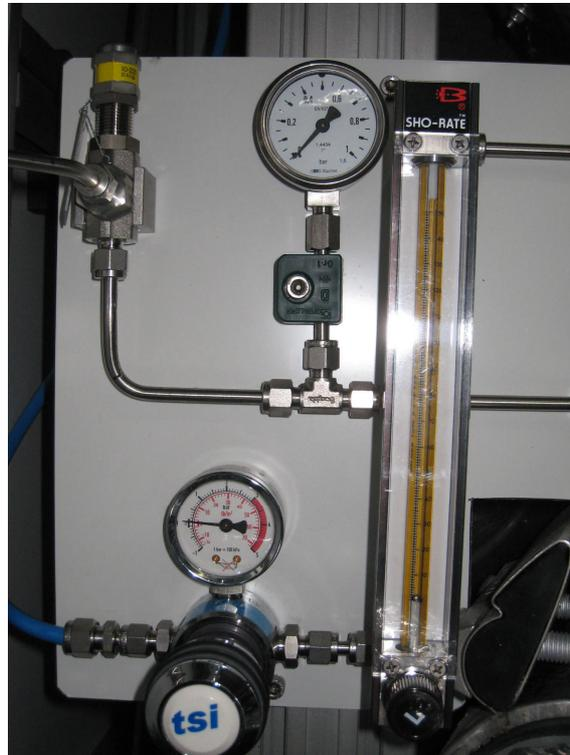
*Figure 34: Aperçu du détendeur et du rotamètre*
