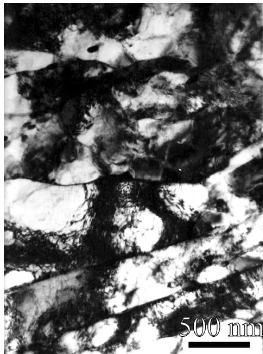
Figure 2.5 – Observations des sous-grains et des dislocations dans l'acier Grade 91 à l'état de réception [24]. La distribution spatiale des dislocations est hétérogène.
