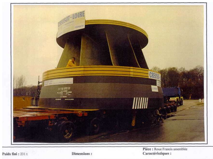
FIG. 1.1 – Roue de turbine hydraulique de type FRANCIS fabriquée par CLI. La pièce finale a un poids de 231 tonnes.
