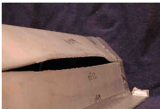
Figure 13 : Rupture d'un longeron automobile en acier Dual-Phase 600 [Hudgins06]
