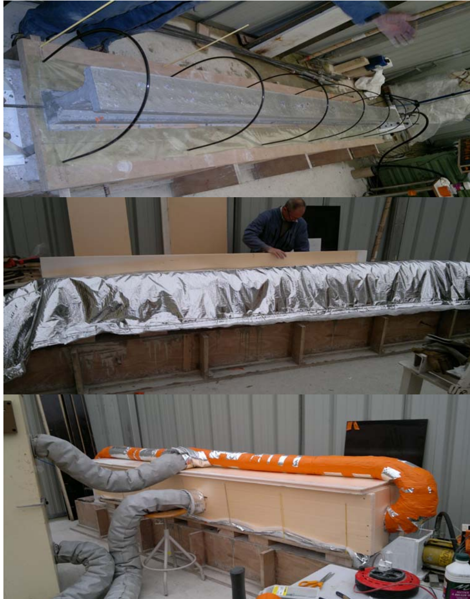
Fig.3.22 Traitement thermique des poutres
