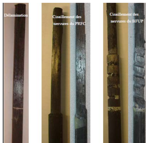
Fig.2.29 Différents modes de rupture
