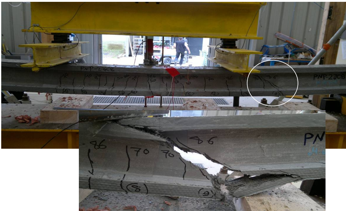
Fig.4.14 Rupture de la poutre PNP-2JC8 par effort tranchant suivie par cisaillement des joncs
