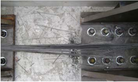
a) rupture du jonc carbone en traction
