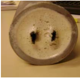
b) rupture par délaminage du jonc
