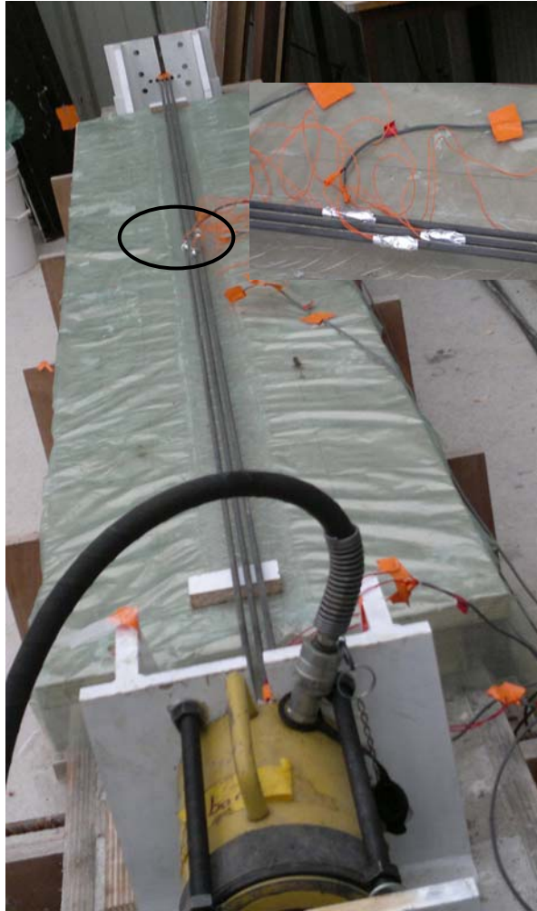
Fig. 3.18 Mise en tension des renforts de précontrainte
