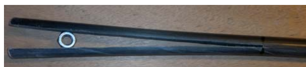
Fig.3.1 Fente longitudinale aux bouts du jonc carbone
