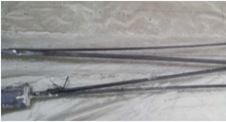
c) rupture par propagation de fente du jonc
