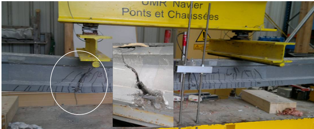
Fig.4.9 Rupture de la poutre PP-3JC8 par effort tranchant suivie par le glissement des joncs
