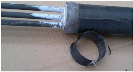
d) plastification du tube acier (épaisseur insuffisante)
