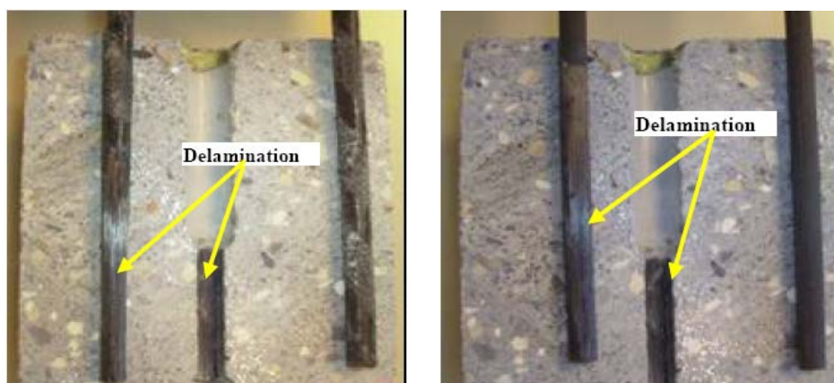
Fig.2.16 Rupture de l'adhérence jonc PRFC-BFUP par délaminage
