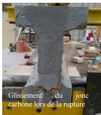
Fig. 4.8 Rupture de la poutre PP-2JC8 par effort tranchant suivie par glissement et cisaillement des jons
