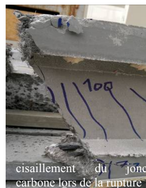
Fig. 4.8 Rupture de la poutre PP-2JC8 par effort tranchant suivie par glissement et cisaillement des jons
