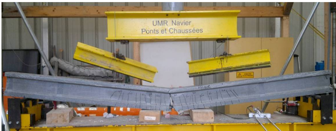
Fig.4.7 Rupture de la poutre PP-JC8 en flexion par rupture du jonc carbone
