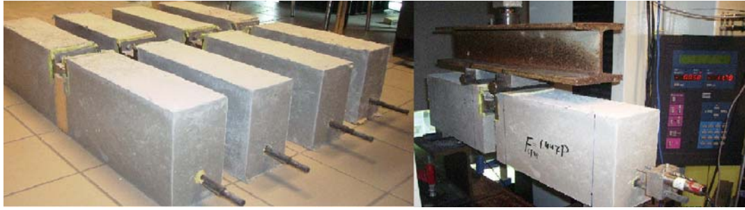
Fig.2.32 Mise en place de l'essai de beam test
