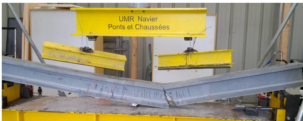
Fig.4.26 Rupture de la poutre PP-JC8TT
