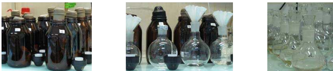
Figure 66 : Remplissage des bombes, filtration après extraction et récupération dans un ballon
