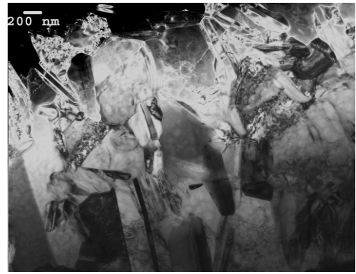
Figure 65 : Micrographie en microscopie électronique en transmission de MP3, après un traitement thermique subsolvus (champ clair).
