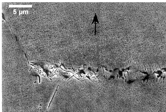
Figure 58 : Micrographie MEB du Nimonic C263 après fluage sous 160MPa à 800°C. [Zhang, 2001]
