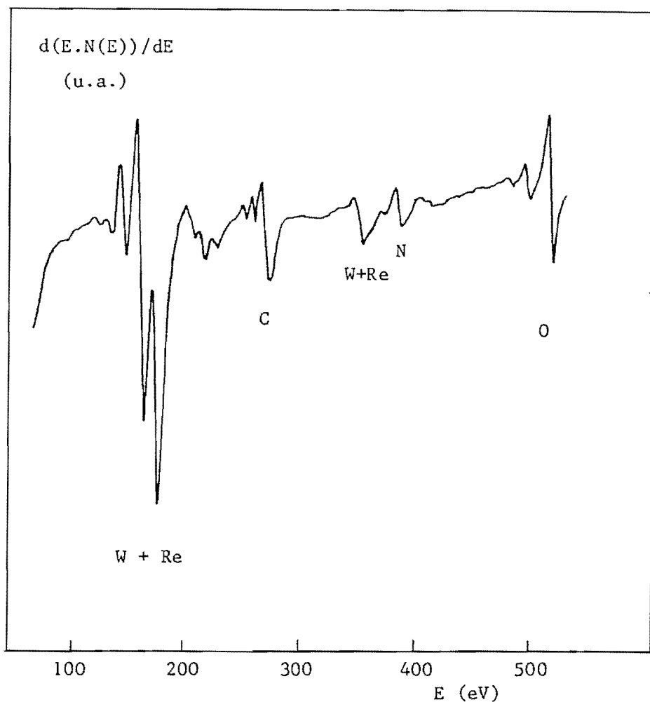
Fig. 45 : Spectre Auger d'une couche mince de WRe.
