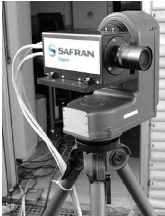
FIGURE 4.15.: Image de la caméra multispectrale sur son trépied. Réalisation Sagem .
