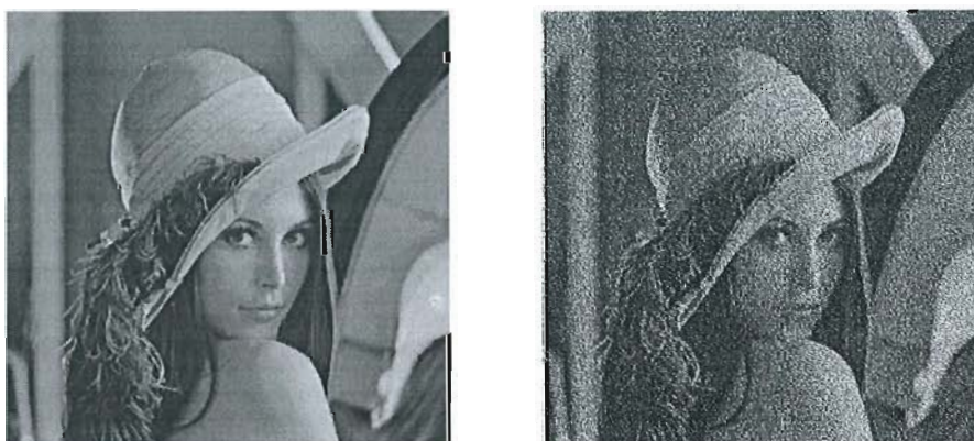
Fig.I.7 : A gauche, une image 476x476 pixels à 256 niveaux de gris (227Ko). A droite, image binarisée par la méthode de diffusion d'erreur (seulement 28 Ko car on n'a pas modifié la résolution). Même pour une résolution à l'impression qui reste assez faible (200ppi), la résolution tonale de l'image est acceptable.
