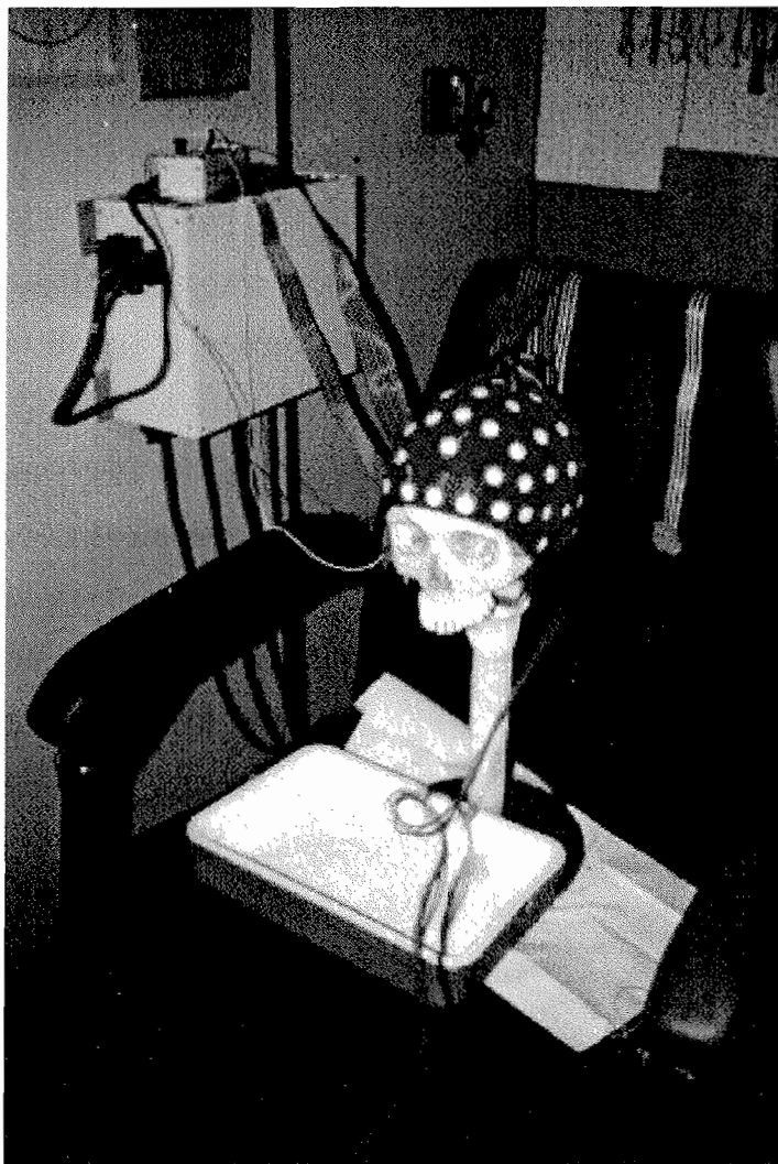
Figure 3a : mesures EEG réalisées sur le fantôme. Le casque (rouge) possède 60 électrodes (ronds blancs). On voit en haut à gauche le générateur de signaux.
