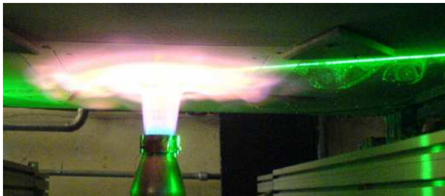
FIG. 2.1 – Banc de l'interaction flamme-paroi (DMAE, ONERA Toulouse).
