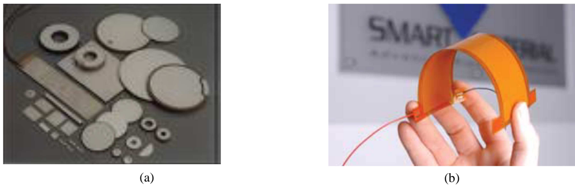
Figure 1.10 : Types de matériaux piézoélectriques : (a) céramiques PZT de différentes formes (b) Macro Fiber Composite (MFC)
