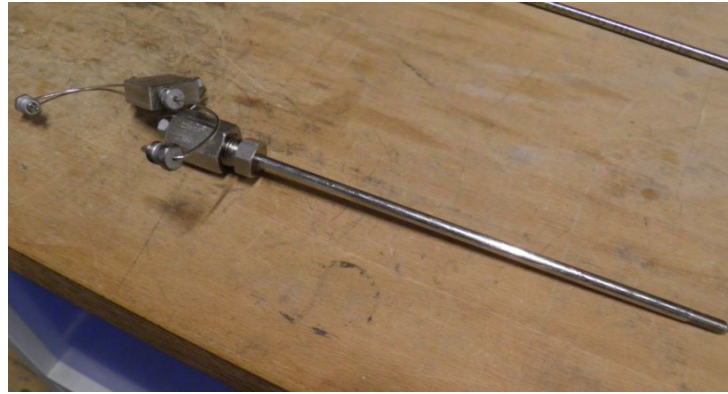
FIGURE 3.22 – Dispositif permettant l'utilisation d'échantillons de diamètre 20 mm dans une cellule hydrostatique.
