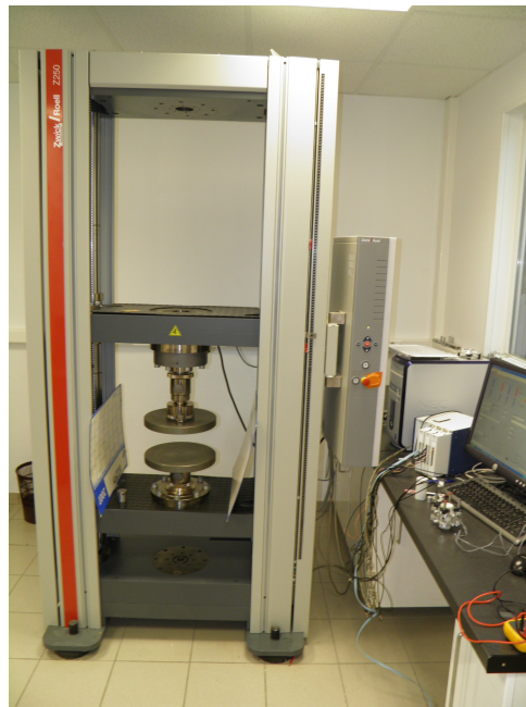
FIGURE 2.2 – Dispositif expérimental pour les essais de compression simple, avec la presse Zwick 250 kN et le système d’acquisition utilisés.
