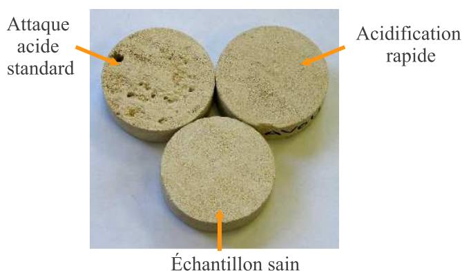
Figure 1.9 – La dissolution de calcaire de Lavoux induit par altération homogène et par attaque acide standard (Egermann, 2005).
