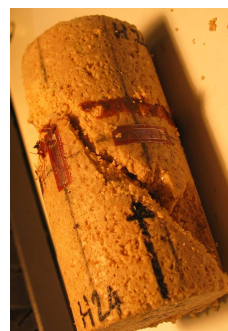
Figure 2.15 – Rupture fragile d'un échantillon soumis 1MPa de pression de confinement effective
