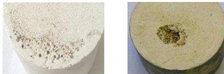
(a) Formation de wormholes (500 cm 3 /h) (b) Dissolution compacte ( 2 cm 3 /h)
