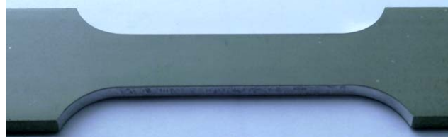
Figure 2.44 Eprouvette de traction en aluminium 2024 avec traitement anticorrosion et peinture d'apprêt, telle qu'un panneau de fuselage d'avion
