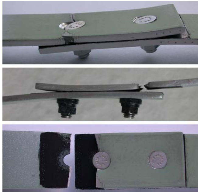
Figure 5.14 Rupture des éprouvettes hybrides
