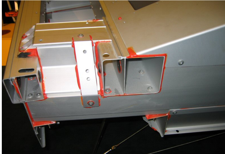
Figure 1.1 Assemblages collés (peints en rouge) sur le châssis de l'Elise
