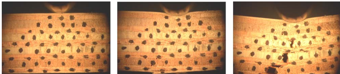
Figure 2.36 Tranche de l'éprouvette lors des essais de flexion trois points sur bois
