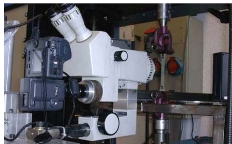
Figure 2.15 Montage de l'appareil photo numérique sur pied motorisé et microscope
