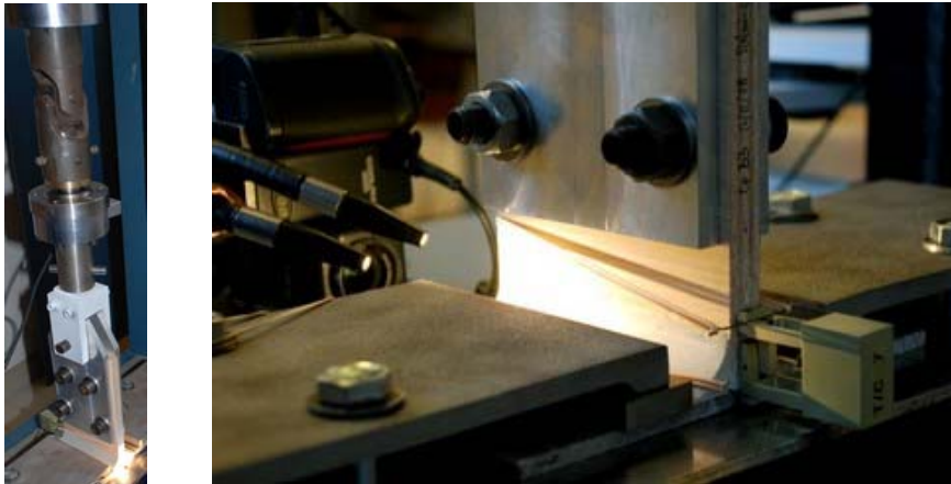
Figure 4.3 Montage d'essai de la liaison en T. A gauche, l'amarrage, à droite, les moyens de mesures : extensomètre sur une face, suivi de points par appareil photo numérique sur l'autre
