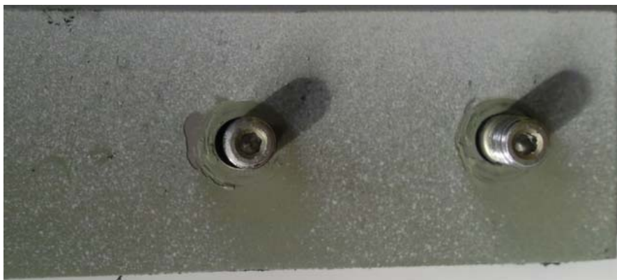
Figure 5.15 Ovalisation des alésages des fixations, substrat du bas
