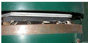
Figure 9.5 Mise sous presse immédiate, 5 MPa de pression pendant 48h
