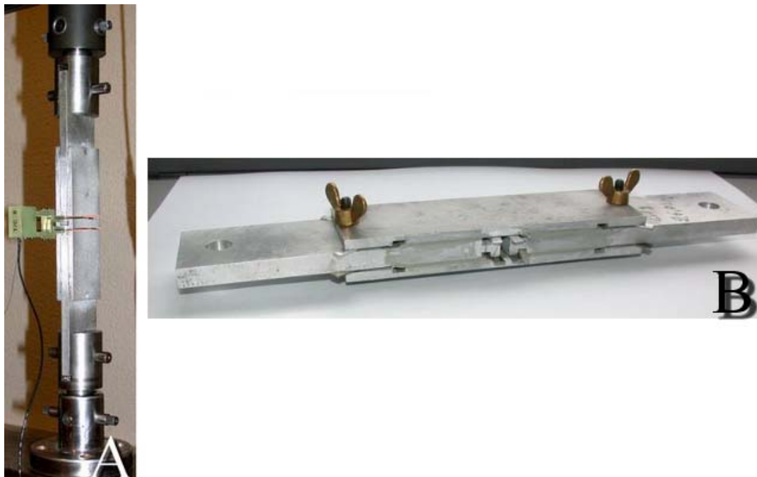
Figure 2.59 En A : montage d'essai de l'éprouvette de quadruple cisaillement. En B, dispositif en cours de polymérisation avec cales d'épaisseur et écrous de serrage
