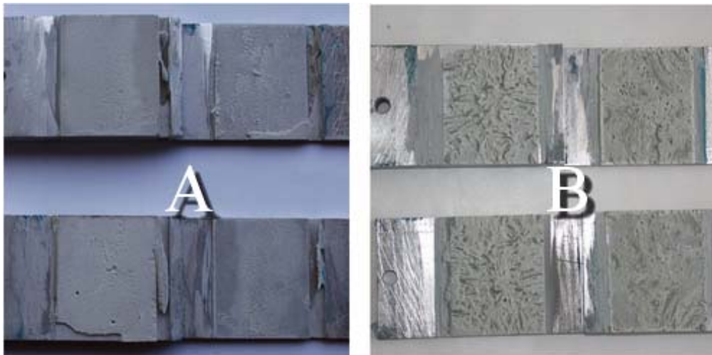
Figure 2.60 En A : faciès de rupture cohésif. En B : faciès de rupture non homogène
