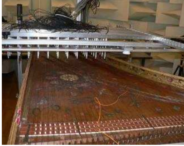
FIGURE 6.1 – Dispositif expérimental d'holographie acoustique en champ proche
