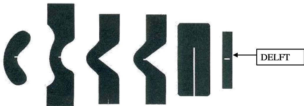
Figure 22 : Epreuves de déchirement.
