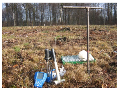
Mesure de la résistance à la pénétration des sols (PANDA®, novembre 2008)
