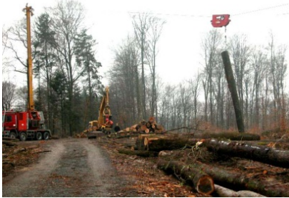
coupe rase et débardage par câble mât (AZ et CA)
