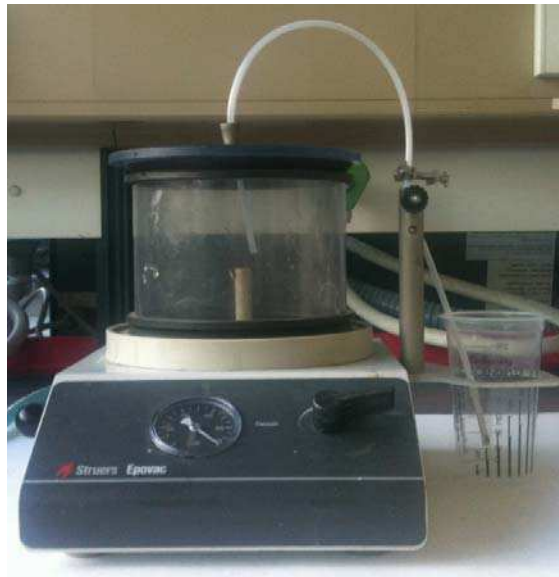
Fig. II.2 Pompe Struers Epovac utilisée pour l'imprégnation sous vide
