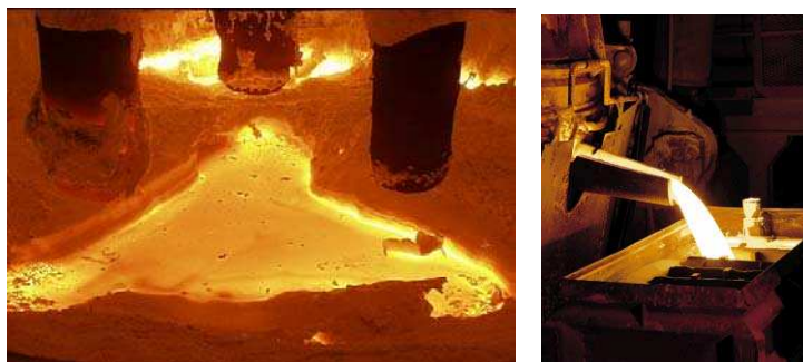
Fig. I.2 Fusion et coulée du THTZ [MAS 05]
