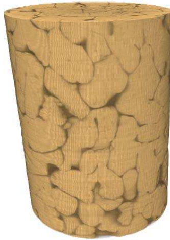
Fig. I.5 Exemple de cylindre observé en tomographie X (ZS). Son diamètre est de 0,5mm et la résolution est de 0,7 \mu m.
