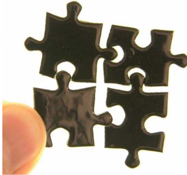
Fig. IV.12 Connexion de type puzzle en 2D
