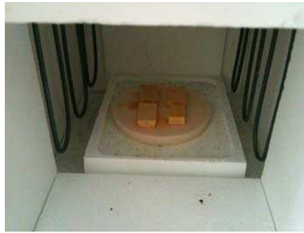
Fig. V.8 Eprouvettes dans le four après essai de cyclage thermique
