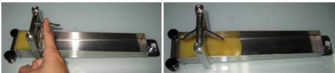
Figure 44. Fonctionnement du consistomètre de Bostwick
