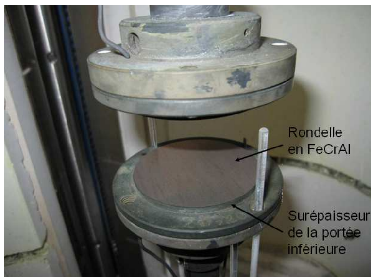
Figure 2.2.11: Mise en place de l'échantillon
