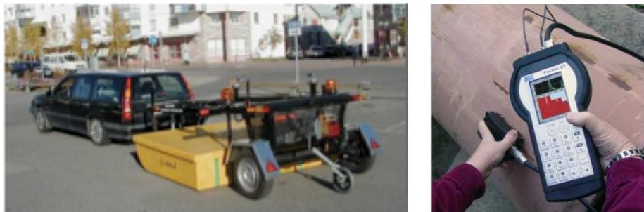
FIGURE 1.2 – A Gauche : Système de sondage du sol. A droite : un système ultrasonique Pocket UT de contrôle non destructif de structures.
