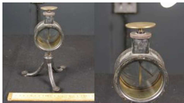
FIGURE 1.2 – Type d'électroscope utilisé par Theodor Wulf pour mesurer le taux d'ionisation de l'atmosphère.
