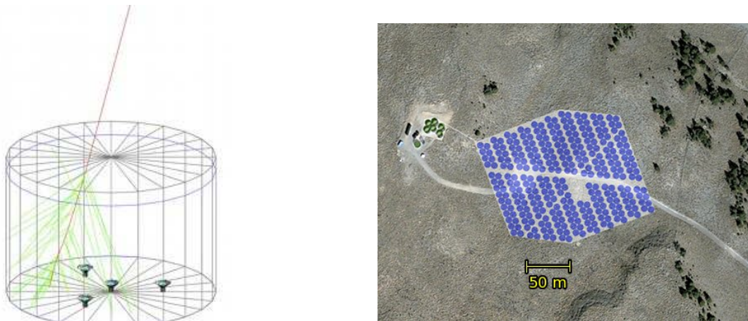
FIGURE 5.9 – Gauche : simulation d'une particule traversant une des cuves à eau de HAWC (en rouge) et émission Tcherenkov créée (en vert). Quatre PMTs sont disposés au fond de la cuve pour collecter la lumière Cherenkov. Droite : agencement prévu des 300 cuves à eau composant le détecteur HAWC. Le prototype VAMOS actuellement en cours de tests est visible sur la gauche. Crédit : http://hawc.umd.edu/ .
