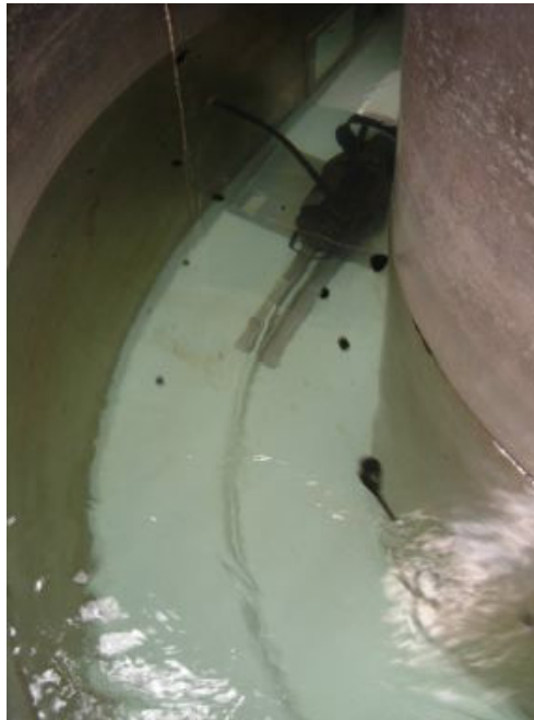
Figure 5.8: Observation de la nappe d'hydrocarbures à la surface du polludrome
