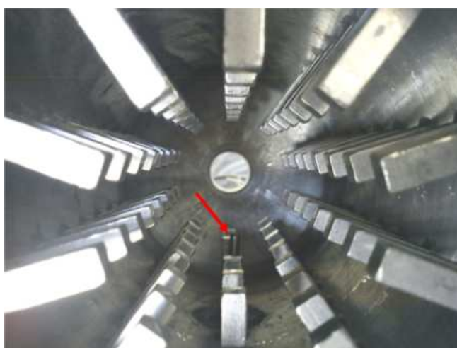
FIGURE II.7 – La sonde de température remplaçant une dent du stator et dont la position radiale est ajustable, permet la mesure de la température du mélange et la commande de l’ultra-cryostat
