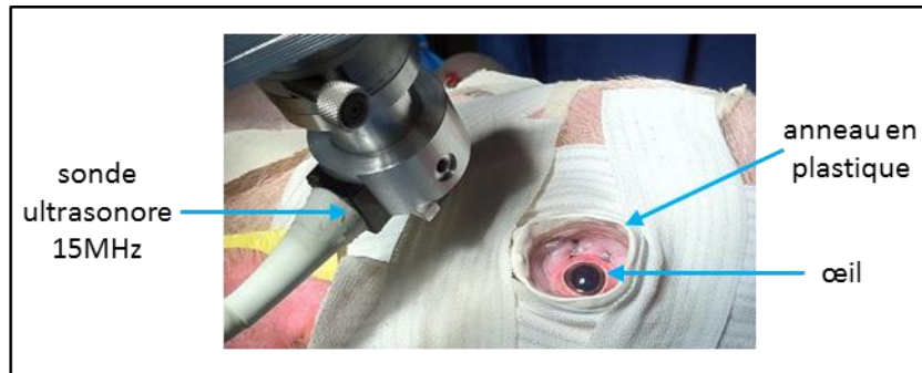
Figure 4.10 – Montage expérimental pour l'élastographie de la cornée in vivo sur un porc anesthésié. Les paupières de l'animal sont maintenues ouvertes grâce à un écarteur palpébral. Un anneau en plastique est positionné autour de l'orbite oculaire afin de former une cuvette étanche permettant d'immerger l'œil dans l'eau. La sonde ultrasonore est montée sur un bras articulé et positionnée à quelques millimètres de la cornée pendant les acquisitions.
